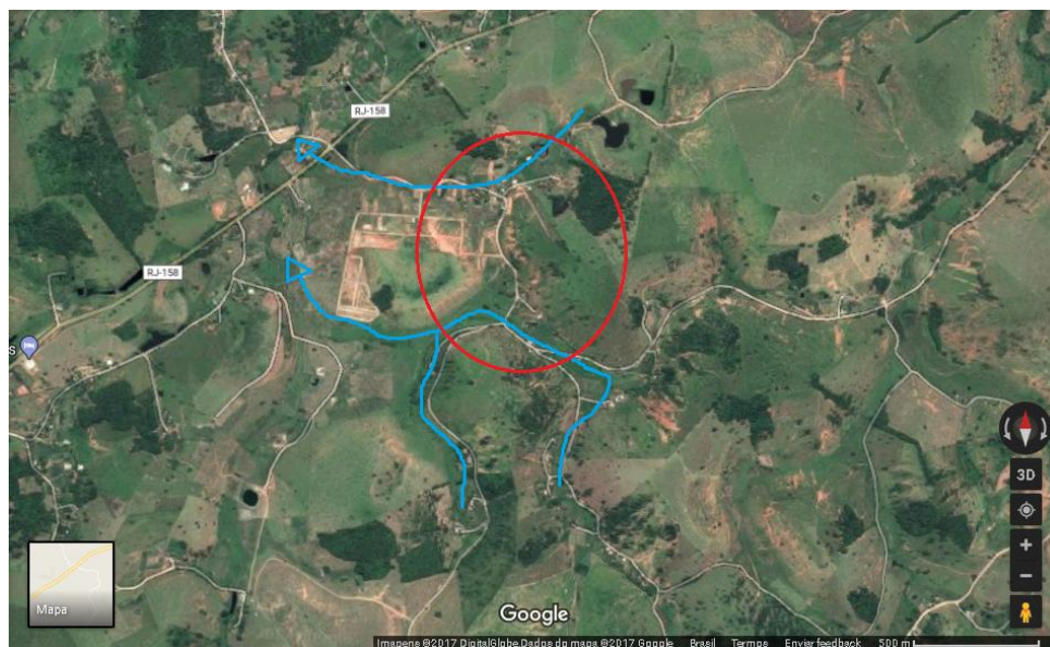
Figura 20: Imagem de satélite referente ao mapa acima, evidenciando os sentidos da drenagem e a presença do divisor rebaixado.
