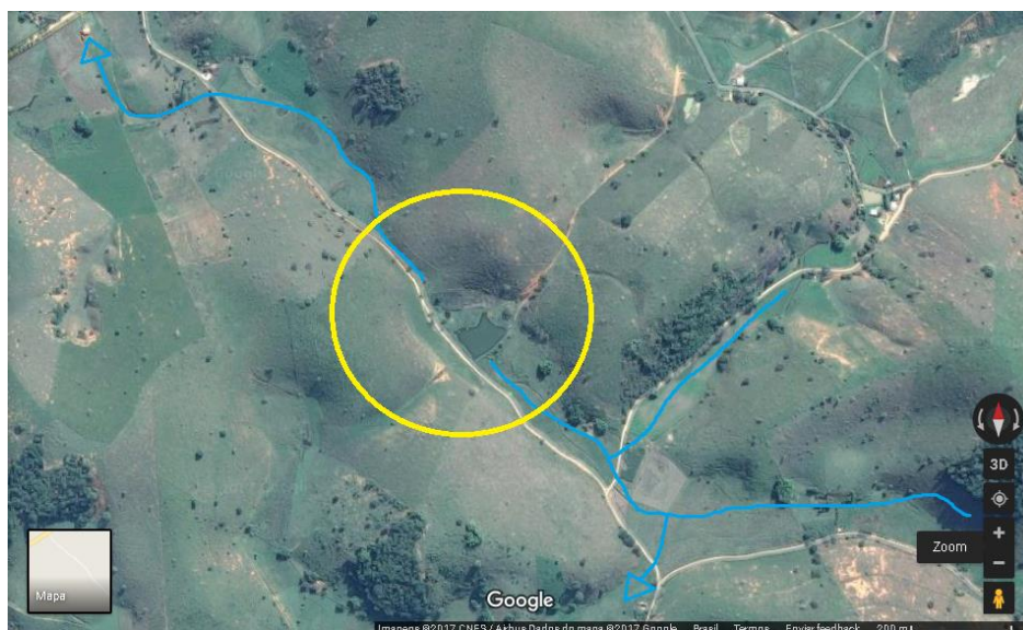
Figura 16: Imagem de satélite mostrando a direção dos fluxos de drenagem e o divisor plano marcado pelo acúmulo de água (lago).
