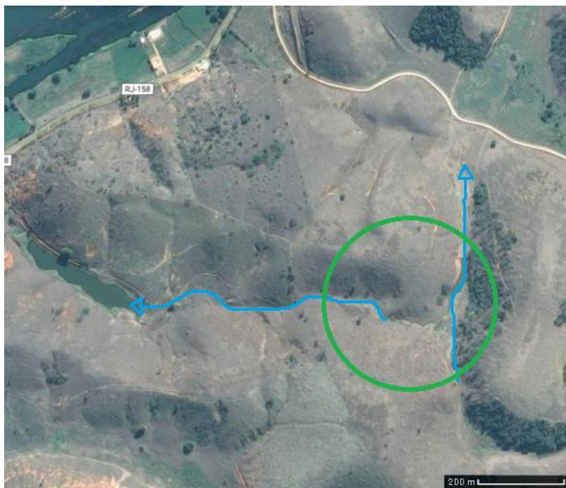
Figura 18: Sentido das drenagens e em destaque o vale seco entre elas. Nota-se um diferencial erosivo devido à maior declividade no caminho seguido pela nova drenagem (à esquerda) e o caminho antigo (à direita) que foi abandonado.
