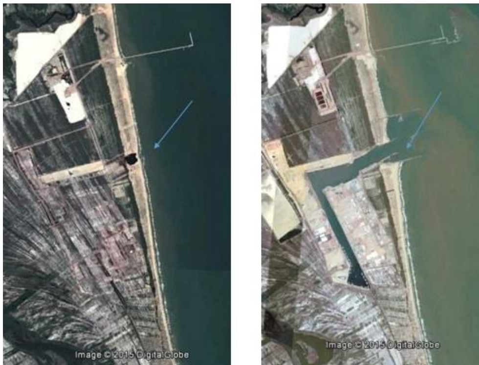
Figura 09 – Comparação entre a linha de costa da área de estudo em 2010 (esquerda) e em 2015. A seta azul indica o local de abertura do canal de navegação, área onde as alterações foram mais acentuadas.
