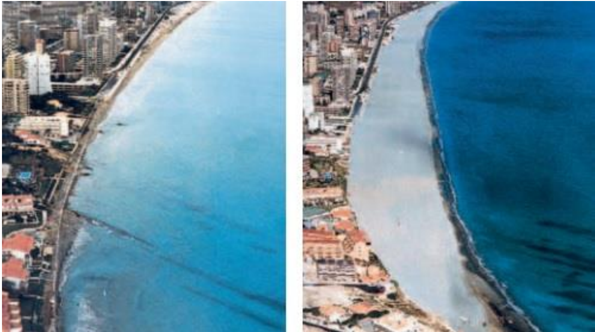
Figura 06 – Exemplo de dragagem realizada em Alicante, Espanha. A imagem compara antes e após o reabastecimento. Disponível em www.iadc-dredging.com .
