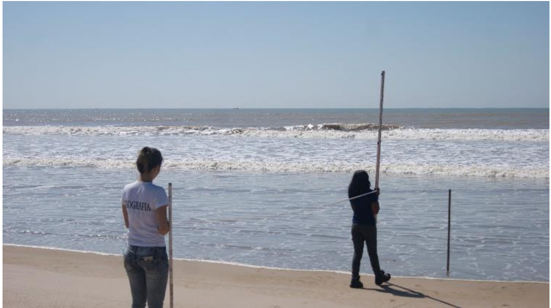
Figura 10. Levantamento topográfico em campo utilizando nível óptico e régua topográfica.
