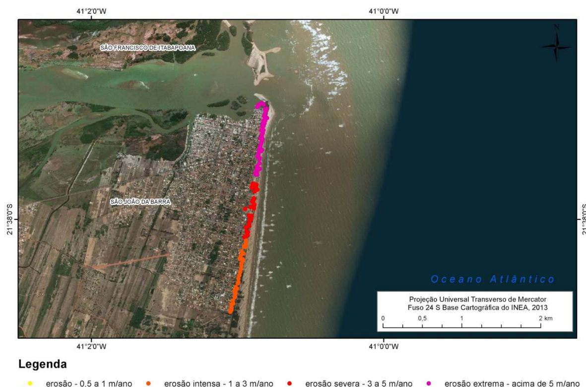
Figura 20. Distribuição das 119 propriedades atualmente na frente de praia em áreas de erosão costeira intensa, severa e extrema na porção norte do litoral de São João da Barra, junto à foz do rio Paraíba do Sul.
