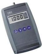
**Barômetro** - Mede a **pressão atmosférica** em coluna de milímetros de mercúrio (mm Hg) e em hectopascal (hPa). **A pressão atmosférica é a pressão que do ar, existente na Atmosfera agindo sobre a superfície do planeta.**
