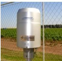
**Pluviômetro** - Mede a **quantidade** de precipitação pluvial (chuva), em milímetros (mm). **A Precipitação ocorre quando o vapor d'água se condensa com as nuvens ocasionando a queda de água dessas nuvens em estado líquido ou sólido, na forma de chuva, neve, granizo.**
