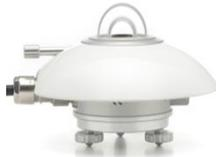
**Piranômetro** - Mede a **radiação solar** global ou difusa, em  $\text{cal.cm}^2.\text{mm}^1$ . **Radiação solar é a quantidade de energia gerada pelo sol, que é recebida sobre a superfície terrestre.**
