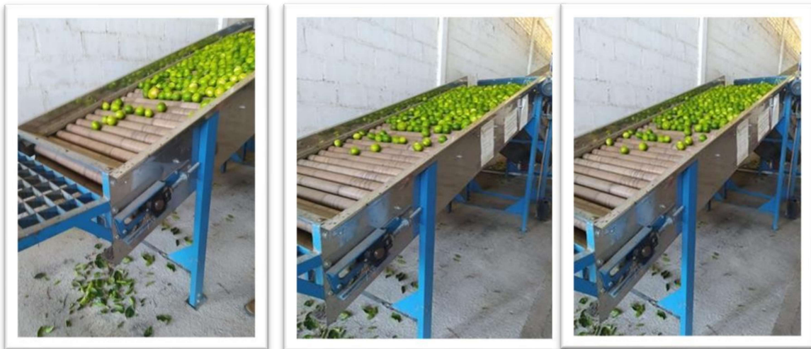
Figura 4: Máquina de beneficiamento de citros- processo onde o fruto é lavado e escovado.
